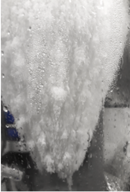
그림2: 실험 간 드라이아이스 냉각기 습도로 인한 빙결정 형성
