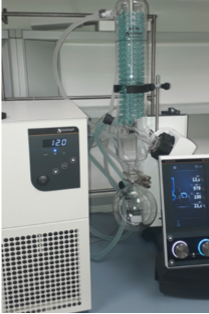
그림4: 재순환 냉각기 포함 회전 농축기 시스템
